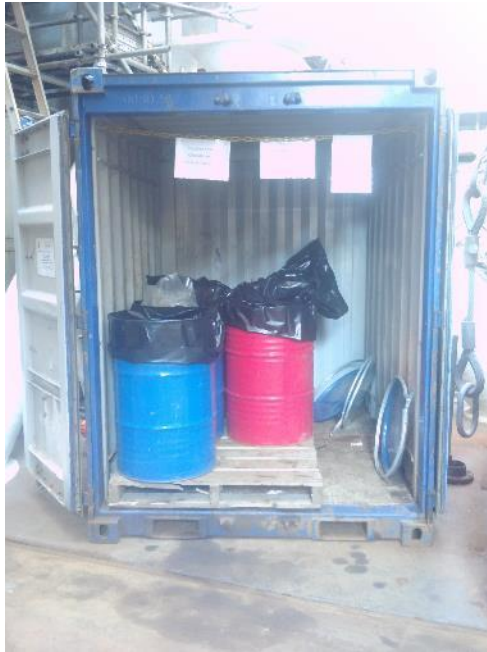
Фото 11. Контейнер для хранения бочек с промасленной ветошью (когда контейнер наполняется, он целиком транспортируется на берег).
